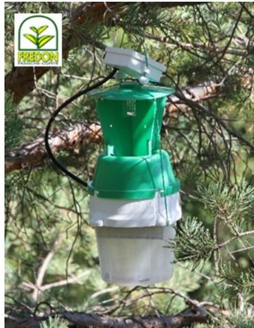
Piège à phéromone à ailette connectée *Captrap*, cellule solaire, géolocalisation et connexion GSM bas débit (avec abonnement téléphonique et interface web).
