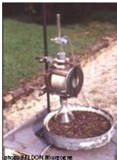
Appareil de mesure des projections de spores d'anthracnose
